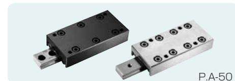
NV形軌道台を組み込んだスライドテーブルです。テーブルとベッドは精密加工されているので高精度が得られ、面倒な精度、予圧の調整などが一切必要無く、そのまま使用できる製品です。
