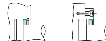
图E-8 毛毡密封环的安装范例
