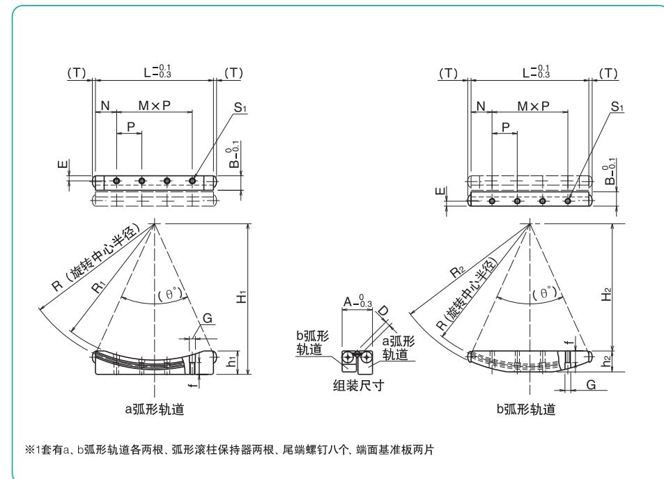
※1套有a、b弧形轨道各两根、弧形滚柱保持器两根、尾端螺钉八个、端面基准板两片
