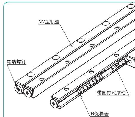
※ NV型在组装前为了保持R保持器中心位置,带有紧固板。请参照P.G-7的安装说明将紧固板取下后使用。
