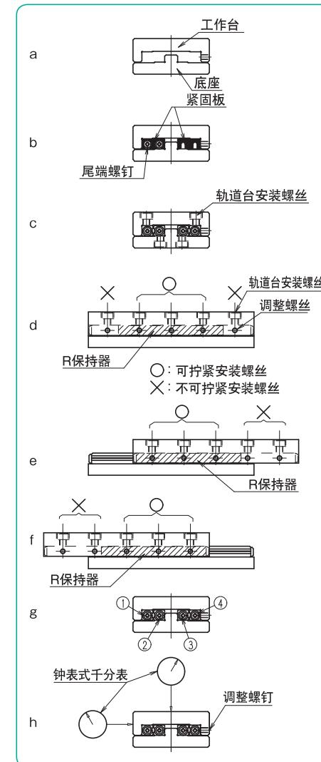
如图d、e、f所示建议将调整螺丝的间隔与轨道台安装螺丝处于同一位置,高度与轨道槽中心配合。
