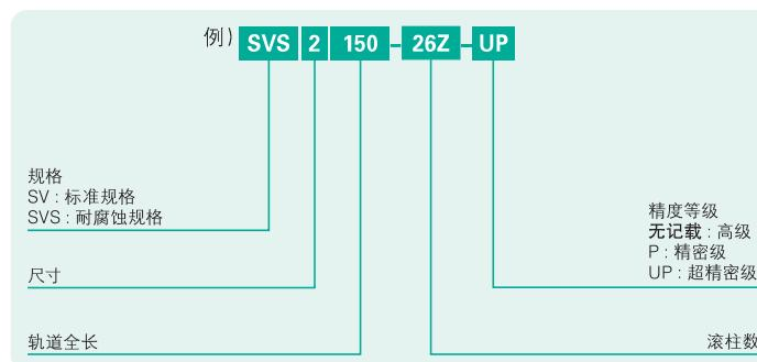
※ 耐腐蚀规格采用不锈钢滚柱。(参考PG-5)
