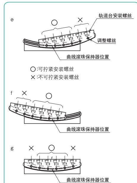
如图e, f, g所示建议将调整螺丝的间隔与轨道台安装螺丝处于同一位置，高度与轨道槽中心配合。
