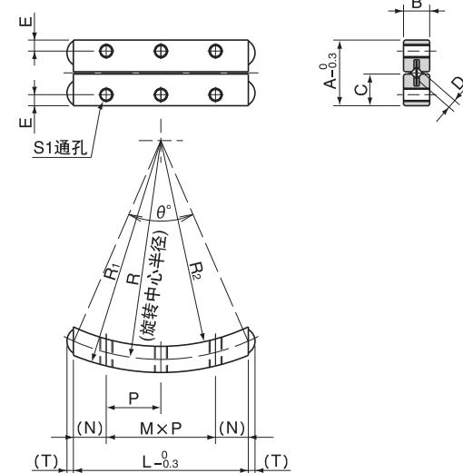
※1套有四根弧形轨道、两根弧形滚柱保持器、八个尾端螺钉。
