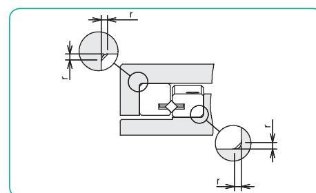
图G-44 安装面的倒角形状
