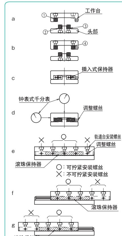
如图e、f、g所示建议将调整螺丝的间隔与轨道台安装螺丝处于同一位置,高度与轨道槽中心配合。
