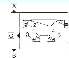
图G-13 安装面的倒角形状
