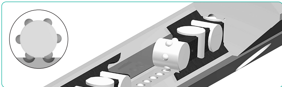
图G-1 圆钉式滚柱防滑系统
